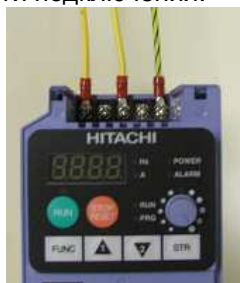
Подключение однофазного инвертора (модели -SFEF и -NFU)
