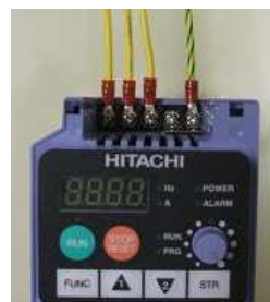
Подключение трехфазного инвертора (модели -NFU, -HFEF, -HFU)
