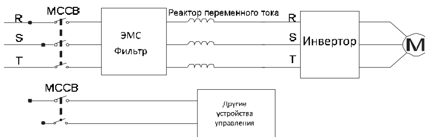
Рисунок 4.7. Подключение на первичной стороне
