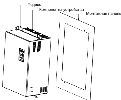
Рисунок 3.6 (б) – 18,5 ÷ 132 кВт. Настенный монтаж
