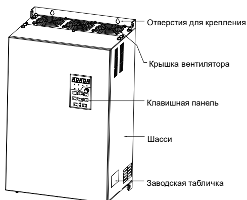
Рисунок 2.4 – Пример компоновки 18,5 ÷ 132 кВт
